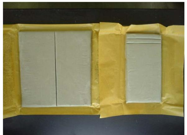
MS-EPは約、厚さ10mm×縦210mm×横210mmの板状に成型して10kg入り段ボールに包装しています。
